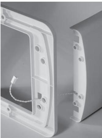
Schieben sie das Scanner Kabel vom Vordach durch den rechteckigen Schlitz des Aussenteils
