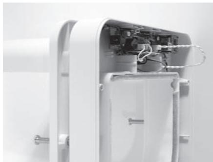
Fixieren sie das Vordach und den Aussenteil am Innenteil mit zwei M6 Schrauben. Stecken sie dann das Scanner Kabel in die elektronische Platte wie gezeigt
